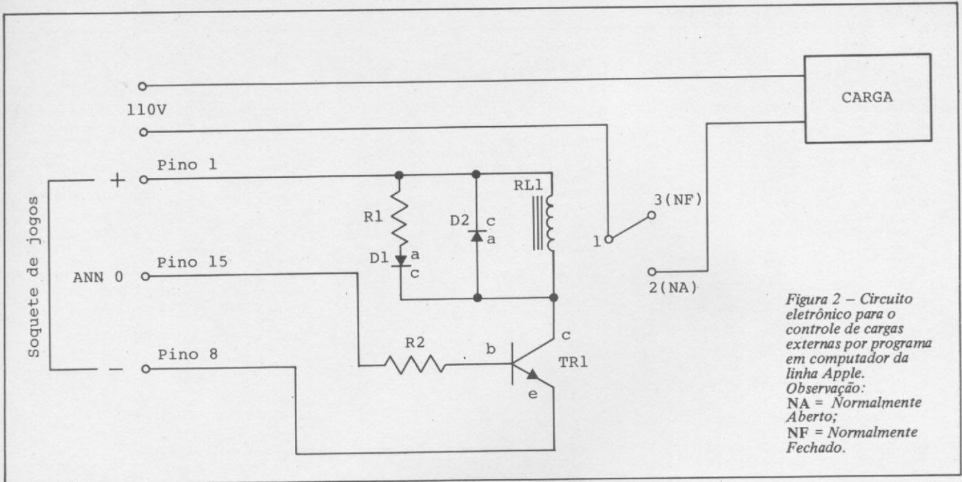
na, indicada pelo apagamento do *led* D1. Isto obriga os contatos 1 e 2 do relé a ficarem abertos, interrompendo a corrente de 110V pela carga. O diodo D2 evita danos sobre TR1 no momento da interrupção do circuito; R1 e R2 são resistores limitadores das correntes em D1 e base do TR1.
